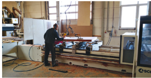
Türblattbearbeitung auf der „Accord 40 FX“
