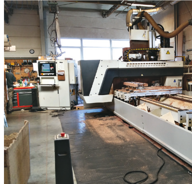
Bearbeiten eines Rahmenteils auf der Traversenmaschine „Record 242 TV“
